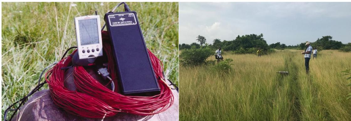
Photo : Matériel TEM et réalisation d'une boucle de mesure
